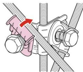
③電動ドライバーなどでボルトを締め付けて完成です。
