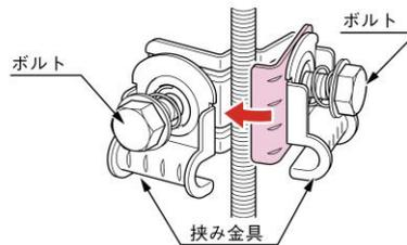
②振れ抑制用全ねじボルトを取り付けます。
