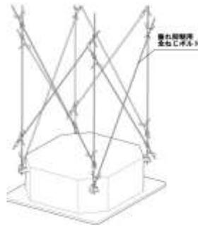
①、②において全ねじボルトが、“脱落防止爪”に乗り上げた状態になっておらず、製品にカン合していることを確認してください。
