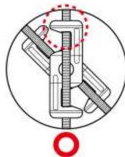
③ 振れ抑制用全ねじボルトにたわみが無いように、製品の取付け位置を調整してください。
