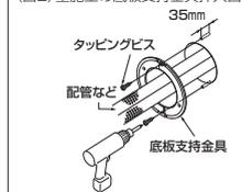
〈図3〉壁両側施工の底板アダプター挿入図
