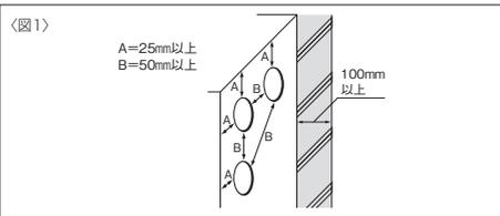
〈表2〉および〈図1〉を参考に、ボイド管等で貫通穴を設けます。
