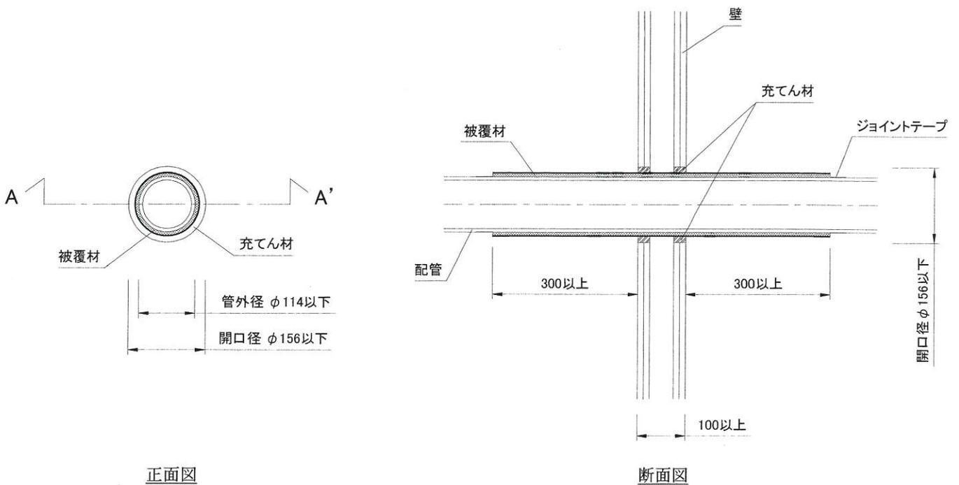
配管呼び径：100 以下の場合
