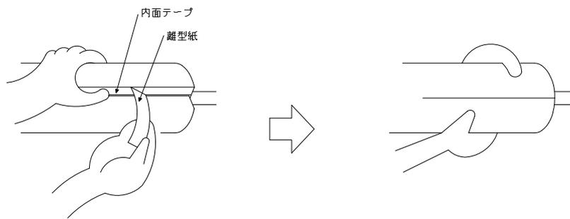
スパイラルフォーム（スリットタイプ）PMH-S の外面テープの離型紙を剥がし、スリット部に隙間が発生しないように手で強く押さえながら、外面テープを貼り付けてください。
