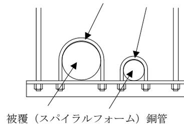
一般に断熱効果を持たない金具を使用する場合は、支持部は保温材のクリープ現象に伴う保温特性の低下を防ぐため、予め断熱粘着テープ (当社型番: DHF-50) 等をスパイラルフォーム (スリットタイプ) PMH-S の外周に巻き付けた上から支持するようにしてください。また、液側配管に裸銅管を使用される場合は、銅管と支持金具が直接接触しない様に絶縁処理された支持金具をご使用ください。
