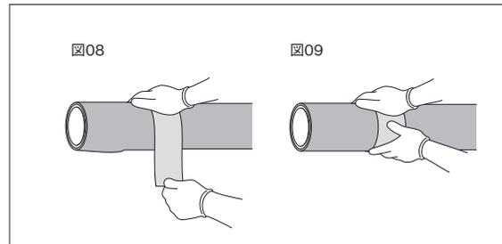
**【注意】** ● ジョイントテープは、配管を一周以上巻き、必ずオーバーラップさせてください。接続部にすき間があると音漏れの原因となりますので注意してください。また、付属のジョイントテープは幅や長さをカットしないでください。
