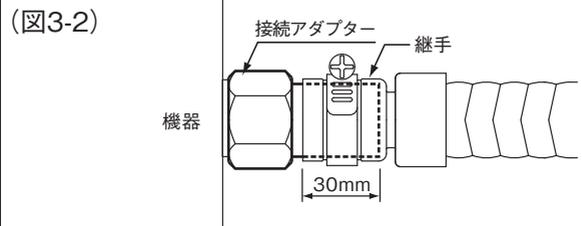
(3) 管の差し込みが完了したら、ホースバンドを締め込みます。スパナなどで目抜き穴が完全に見えなくなるまでしっかりと締め付けてください。(目安トルク400N・cm)(図3-3)
