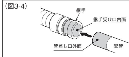
(3) 塗布後、ただちに管をひねらず真っ直ぐに一気に差し込み、管が抜け出てこないように管と継手を30秒以上保持してください。
