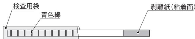
④ 通水試験時に継手部で漏水があると青色線が消えます。
