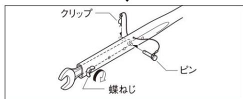
本体は固定し、ナットのみを締め付けますが、必ずナットが本体に当たるまで完全に締め付けてください。**締め付けはナットと本体が当たった時点で完了です。**
