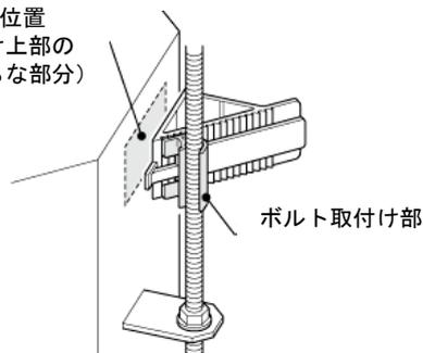
FL-YK の取付け位置を確認し、ボルト取付け部を機器の吊りボルトにはめ込みます。
