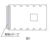
掃除口部に本体シートの切欠き部を差し込み巻きつけて、 背貼りテープの剥離紙を剥がして貼り付けてください。 (図2.3)
