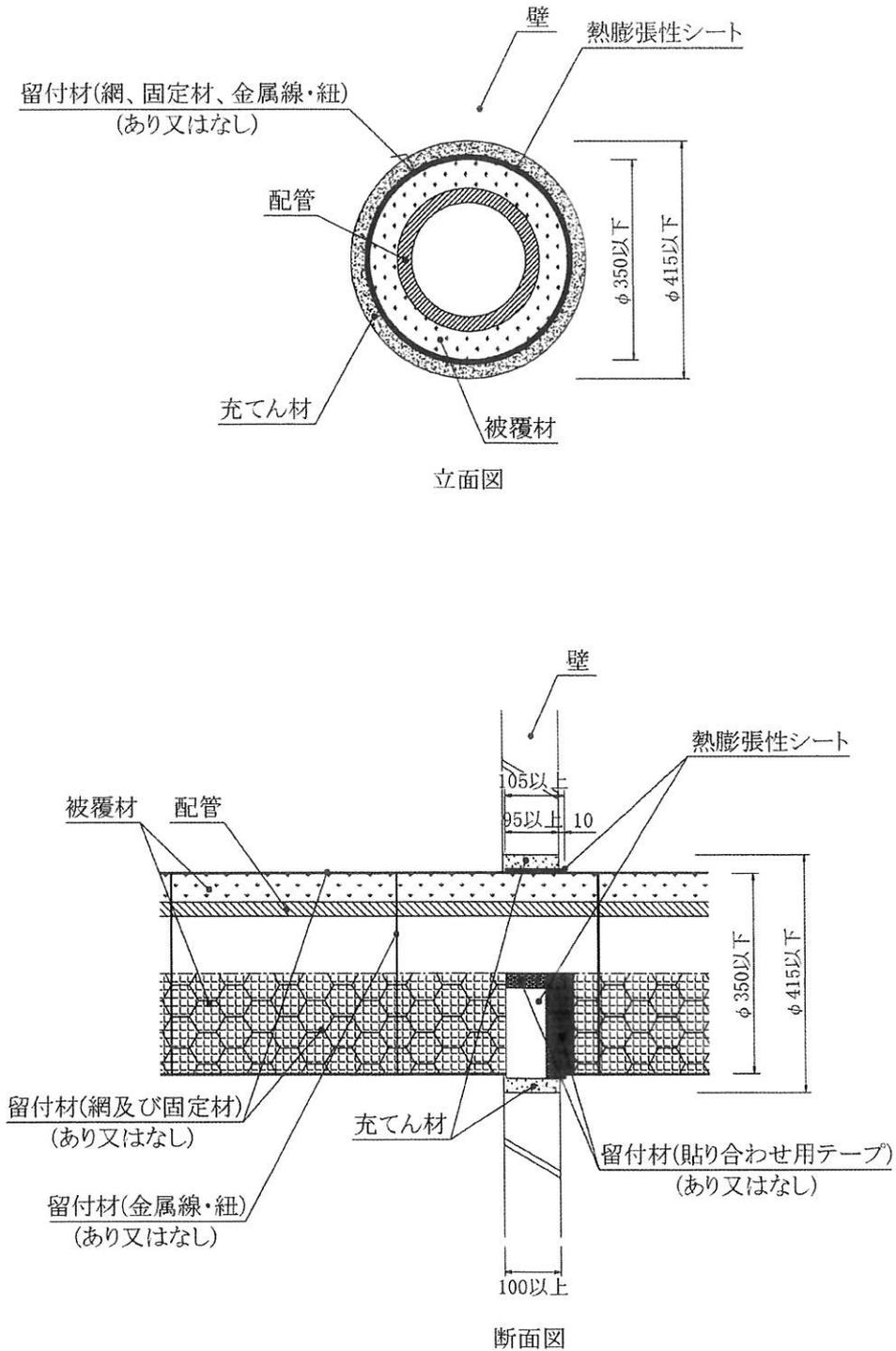
図1 構造説明図 (施工図)
