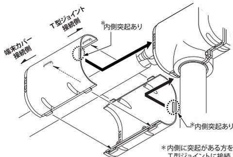
\*内側に突起がある方をT型ジョイントに接続してください。
