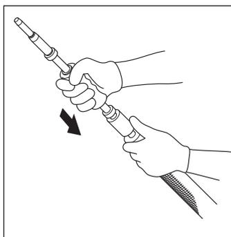
3. パイプにダイスを押し込んだ後、ポンチをダイスの内径に差し込みポンチのにぎり手をたたき込んでください。
