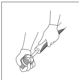
1. 銅管をカッターで切断後内面のバリ取りを確実に行ってください。
