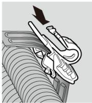
矢印の方向に支持具を押し込みスーパーロックに取付けます。
