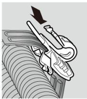
矢印の方向に支持具を押し込みスーパーロックに取付けます。
