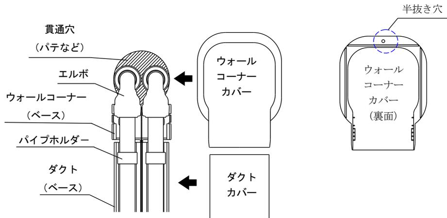
注意) カバーがガタつく場合は、カバー裏側に半抜き穴を設けていますので、ビス止めしてください。
