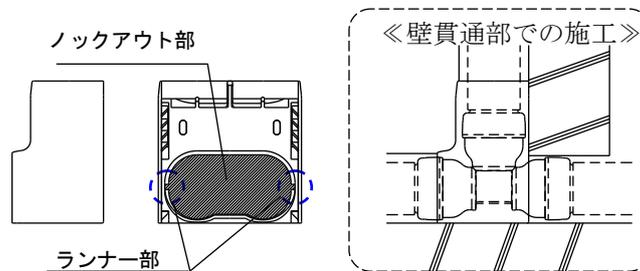
注意) 施工時に配管や保温材のキズつきや損傷を防止する為、カット部にささくれなどが発生しないように処理をしてください。
