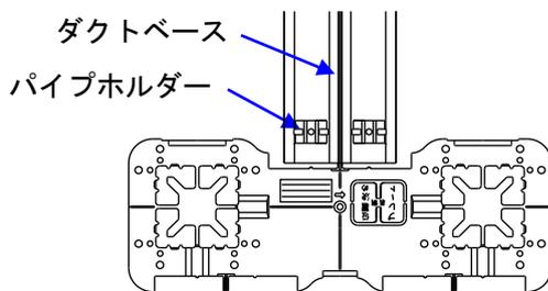
ビス止めピッチは、500mm 以内とし、とくにダクトのベース端部(端から約 25mm)は、ビス止めを行ってください。
