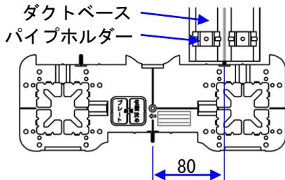
パイプホルダーおよびビス止めピッチは、500mm 以内とし、とくにダクトのベース端部（端から約 25mm）は、必ずパイプホルダーと一緒にビス止めを行ってください。
