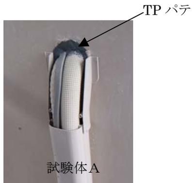
写真-3 加熱前施工状況
