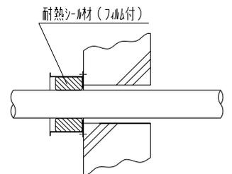
⑤ 耐熱シール材の充てん・仕上げ残りの隙間に耐熱シール材を全て充てんし、隙間が無く、面一であることを確認し、脱落しないように仕上げる。
